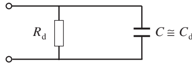
Figure D.15 Schéma équivalent d'une diode polarisée en direct
